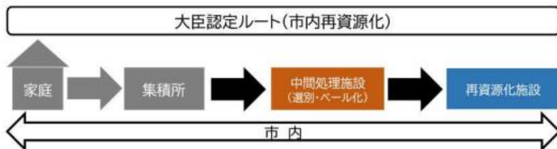
図 静岡市が求める中間処理・再資源化処理の市内完結型
