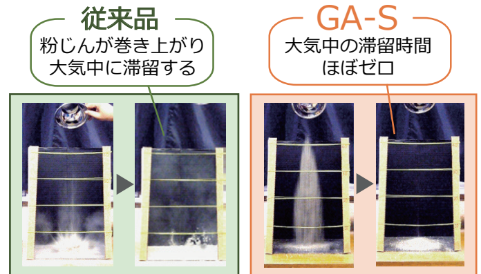
▲地盤改良材投下実験(投下高さ 50cm)
