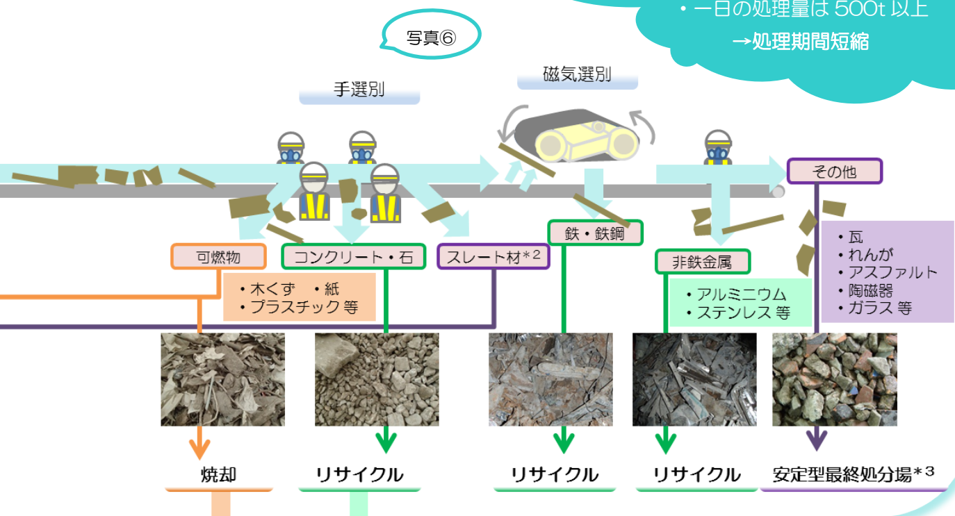
図 津波堆積物処理残渣減容化処理フロー
