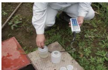
排水のpH測定 (横浜リサイクルセンター)
