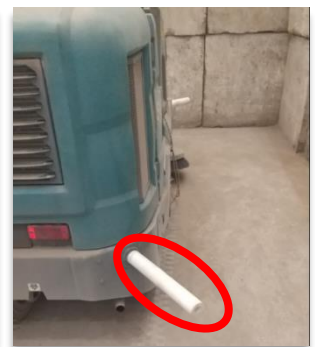
清掃車の接触事故防止対策
